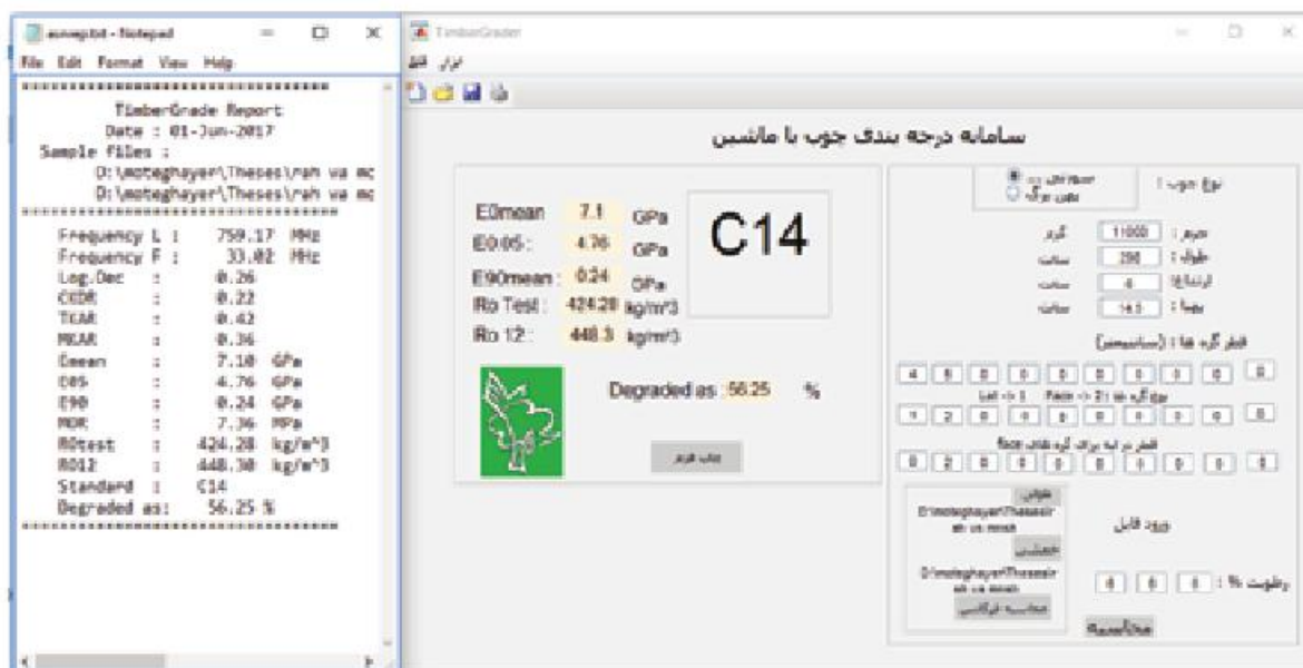
شکل شماره ۳. گزارش دستگاه ایرانی درجه بند ماشینی چوب برای تخته وارداتی سوزنی برگ که به ظاهر سالم و کم گره ولی حاوی بیش از ۵۶ درصد افت ارزش کیفی ناشی از معایب درونی و مخفی
